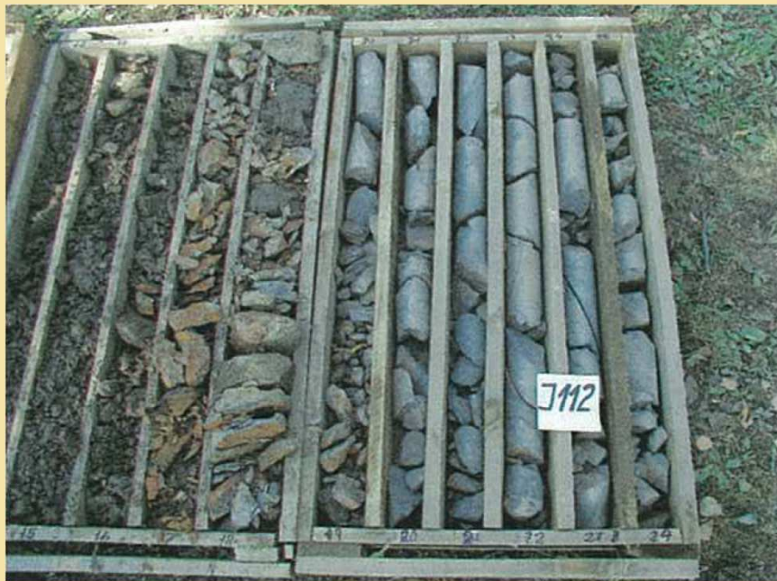
Výnos vrtného jádra
