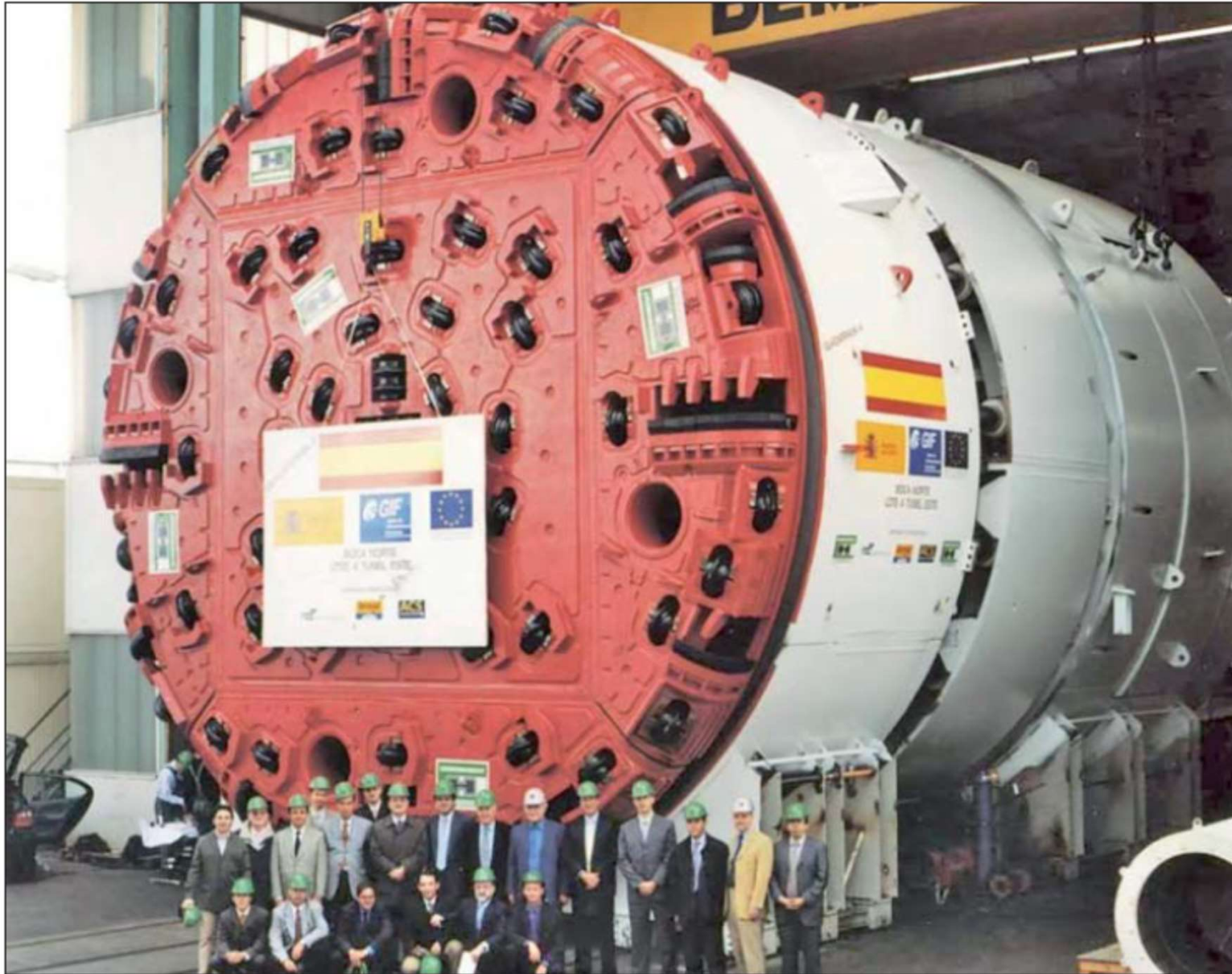
Razicí stroj s dvojitým štítem ( průměr 9,5 m, Guadarrama North)
