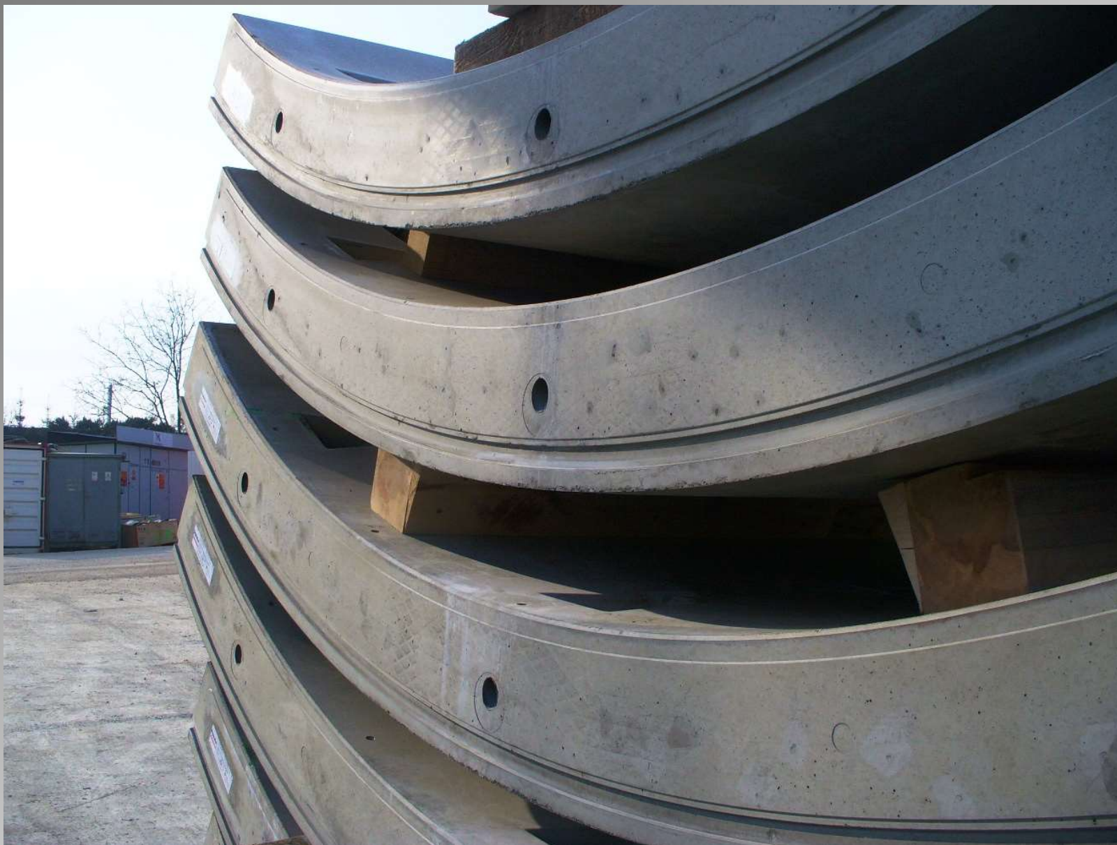
Praha – prodloužení „A“ – drážka pro vlepění pryžového těsnění
