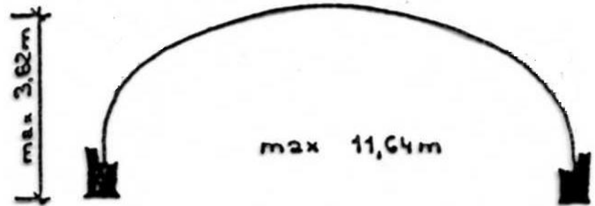
Elipsa pro velká rozpětí
