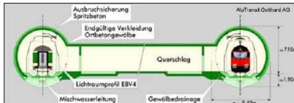
Příčný řez tunely
