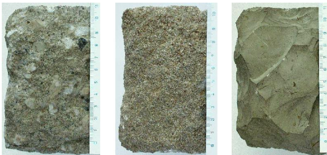
Obr. 17: Struktury klastických sedimentů dle velikosti zrn – zleva psefitická, psamitická a politická (převzato z Chamra et al., 2005).
