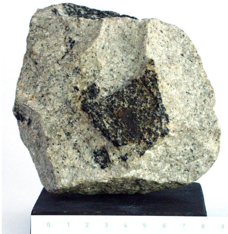
Obr. 13: Aplitická struktura (aplit) (převzato z Chamra et al., 2005).
