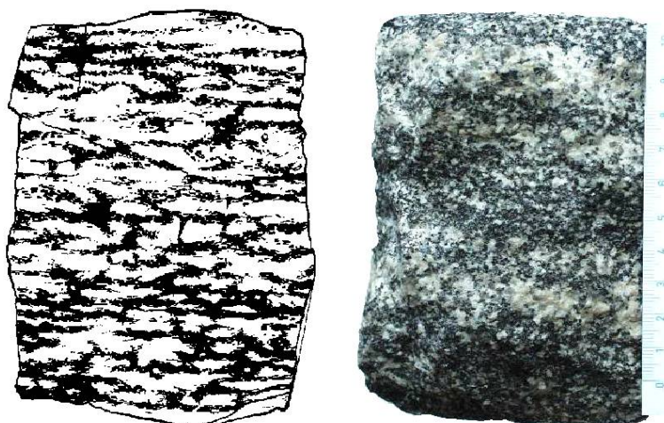
Obr. 8: Paralelní textura (pararula) (převzato z Chamra et al., 2005).
