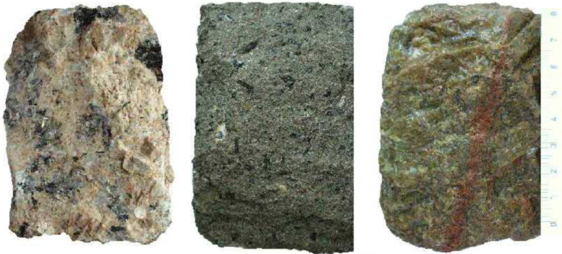
Obr. 10: Struktury vyvřelých hornin dle vývoje součástí – zleva celokrystalická, polokrystalická a sklovitá (převzato z Chamra et al., 2005).
