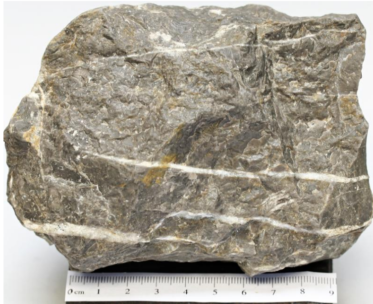
Obr. 21: Kalová struktura vápence.
