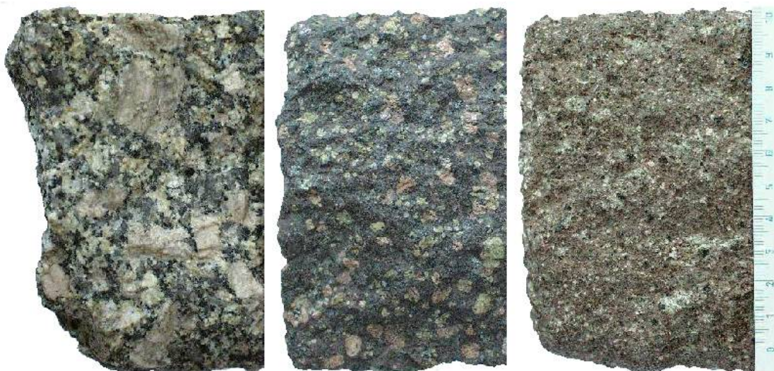
Obr. 15: Struktury dle přítomnosti vyrostlic – zleva porfyrovitá (hlubinné h., žula), porfyrická (žilné h., žulový porfyr) a porfyrická (výlevné h., křemenný porfyr) (převzato z Chamra et al., 2005).
