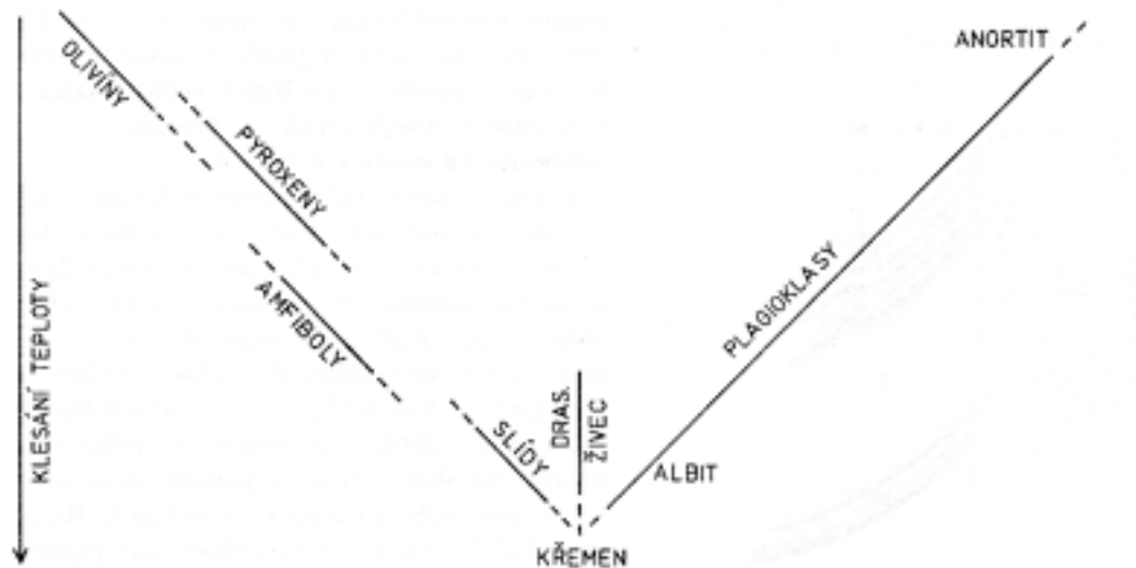
Obr. 1: Postup krystalizace minerálů alkalicko-vápenatých magmat (převzato z http://www.geology.cz/aplikace/encyklopedie/term.pl ).
