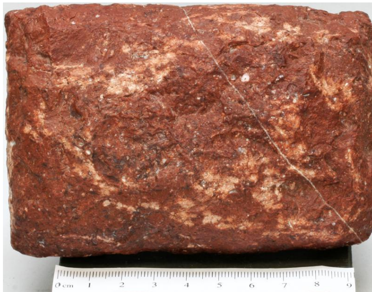
Obr. 20: Organodetritická struktura vápence.
